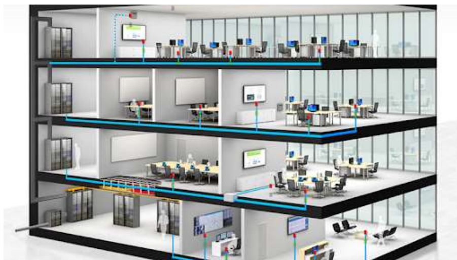
Figura #6. Cableado estructurado con normativa ANSI/TIA/EIA.
