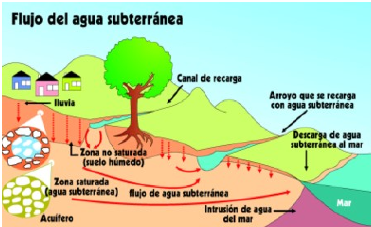
Figura N° 2: El principio de la infiltración-flujo subterráneo-recarga.
